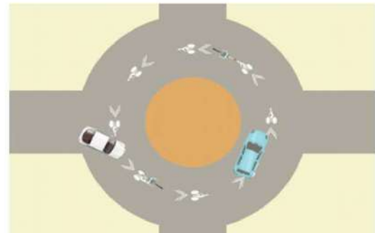
Illustration 3: Marquage de trajectoire vélo à l'axe de l'anneau du giratoire
