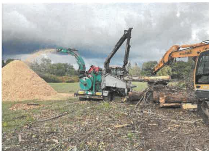
Figure 50 : Broyage des peupliers en vue de leur réemploi dans les cheminements - BEZONDE
