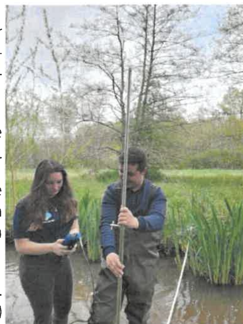
Figure 28 - Prise de mesure avec un courantomètre - Le Vernisson à Nogent-sur-Vernisson – PUISEUX-VERNISSON
